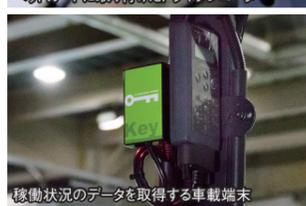
稼働状況のデータを取得する車載端末
