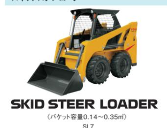
**SKID STEER LOADER** (バケット容量0.14~0.35m<sup>3</sup>) SL7
