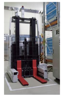
**現場解説** レーザー誘導方式無人フォークリフト「プラッターオート」導入による24時間自動搬送システム
