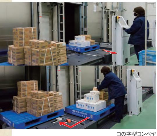
るなど、とことんまで当社の要求に応える姿勢をみせてくれました。結果、当初提案では約1,000パレットだった収納数を約1,200パレットにまで引き上げることができました。また、パレット単位で入出庫するエリア、バラでピッキングする荷受場を分け、荷受場のほうはコンベヤを「コ」の字にしました。出てきたパレットから人の手でバラピッキングし、パレットを倉庫内に戻していく、流れるような作業フローを実現。冷凍庫内でのピッキング作業がなくなり効率化が進みました。
