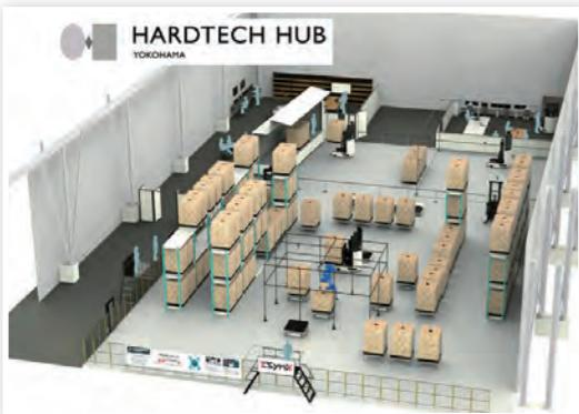
三菱重工が研究開発を進める「ΣSynX(シグマシンクス)」※3のコア技術を適用して物流を知能化・自動化するプロジェクトに参画し、自動化ソリューションの開発に取り組んでいます。現在、その第一弾として飲料ピッキングの自動化ソリューションを開発中であり、2022年度に三菱重工運営の「Yokohama Hardtech Hub」での実証を開始する予定です。無人フォークリフトや無人搬送車、パレタイザーを連携させることで多数の作業者が従事するピッキング作業の自動化を目指しています。
