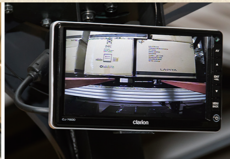
フォークに取り付けられたカメラを通して安全な荷役作業をサポート
