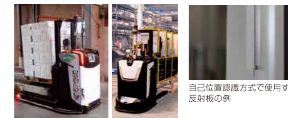
レーザー誘導式無人フォークリフトの導入例
