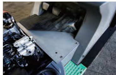
1 運転席フロア部をステンレスプレートで強化。
