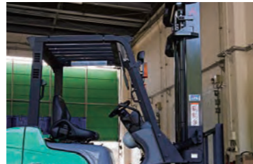
3 防錆塗料をヘッドガードまで塗装。
