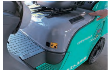
2 運転席下の鉄板カバーをFRP加工。
