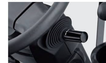
操作しやすいレイアウトの前後進切替レバー
