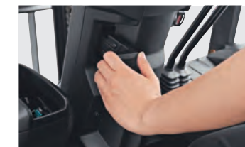
操作しやすいレイアウトの前後進切替レバー
