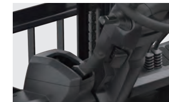
ステアリングの角度を使いやすい位置に容易に調整可能なリリースレバー
