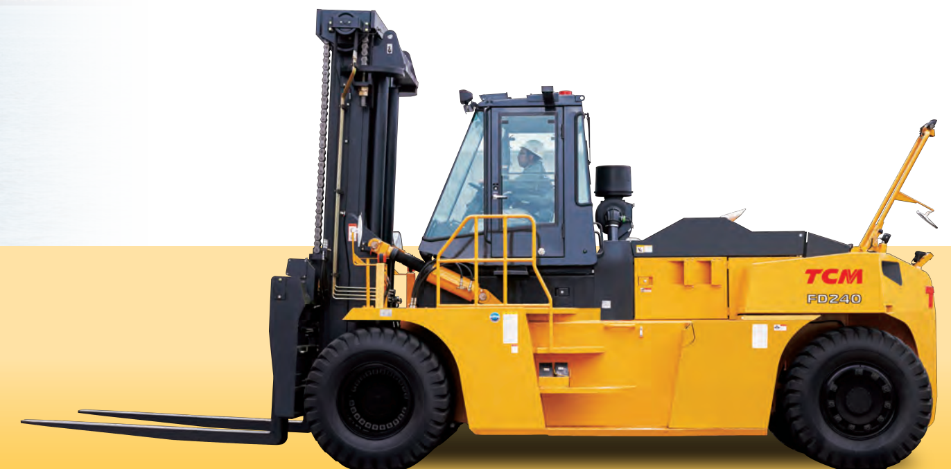
大型フォークリフト FD Series 24 ton FD240-5 24000kg / 1250mm ※本カタログ掲載の車両はオプション装備車です。
