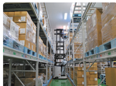
車幅とほぼ同等の道路幅で荷役作業ができ、スペースを有効利用。
