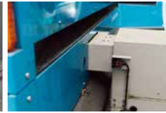
電圧低下を検知すると自動充電ステーションに移動し、急速充電
