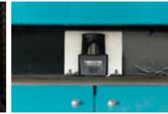
車両の周囲10カ所に障害物センサーを設置
