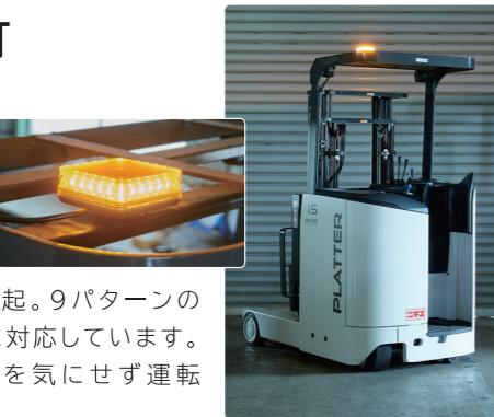
回転灯で注意を喚起。9パターンの点滅・点灯・回転に対応しています。薄型タイプで全高を気にせず運転可能です。
